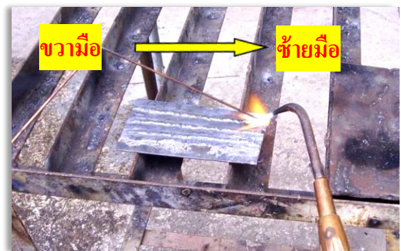
แสดงลักษณะการเชื่อมถอยหลัง
