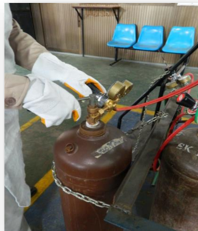
แสดงการไขล็อกเปิด วาล์วหัวถังแก๊สอะเซทิลีน
