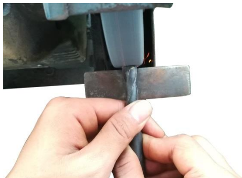
รูปที่ 5.28 แสดงการลับปลายดอกสว่านเดิมออก (ที่มา : สุรัชย์ บุญโสภณ, 2559)
