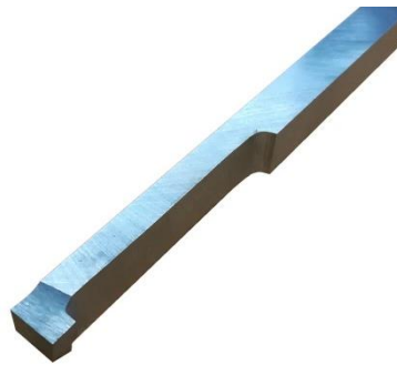
รูปที่ 4.145 แสดงลักษณะของมีดกลึงคว้านรูในที่ลับจากเหล็กกล้าความเร็วสูงขนาด 3/8x3/8 นิ้ว (ที่มา : สรุชัย บุญโสภณ, 2559)
