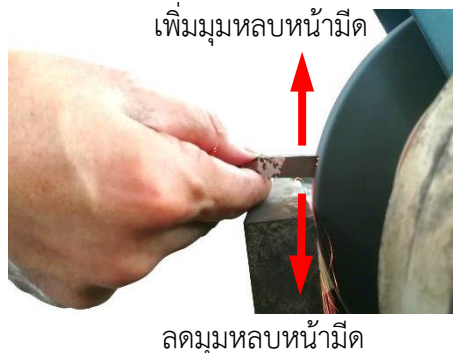
รูปที่ 4.87 แสดงแนวในการแก้ไขมุมหลบหน้ามีด (ที่มา : สุรัชย์ บุญโสภณ, 2559)
