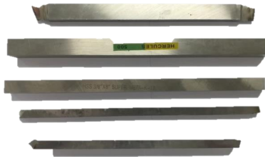
รูปที่ 4.28 แสดงลักษณะของมีดกลึงลักษณะแบบเป็นแท่ง (ที่มา : สุรชัย บุญโสมณ, 2559)
