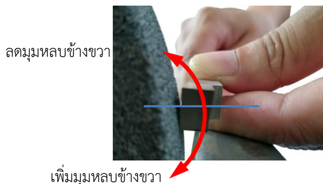
รูปที่ 4.116 แสดงแนวในการแก้ไขมุมหลบซ้ายขวา (ที่มา : สุรัชชัย บุญโสภณ, 2559)
