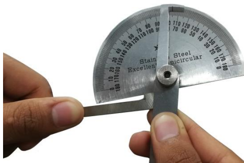
รูปที่ 4.163 แสดงการวัดตรวจสอบมุมรวมปลายมีดกลิ้งคว้านรูใน (ที่มา : สุรัชย์ บุญโสภณ, 2559)
