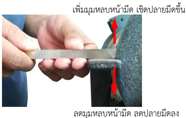
รูปที่ 4.100 แสดงแนวในการแก้ไขมุมหลบด้านข้าง
