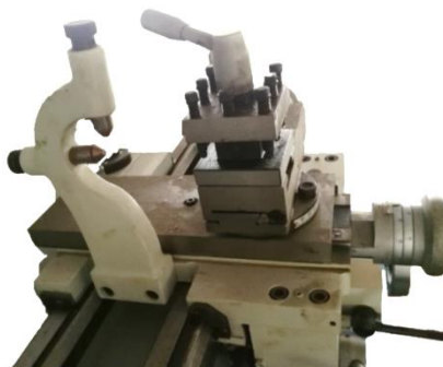
รูปที่ 4.27 แสดงลักษณะของก้านสะท้อนตาม (ที่มา : สุรัชย์ บุญโสภณ, 2559)
