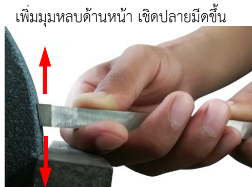
รูปที่ 4.160 แสดงแนวในการแก้ไขมุมหลบด้านหน้า (ที่มา : สุรัชย์ บุญโสภณ, 2559)
