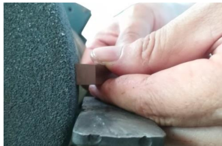
รูปที่ 4.132 แสดงการลับมุมหลบด้านข้างขวา (ที่มา : สุรัชย์ บุญโสภณ, 2559)
