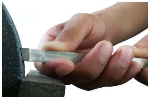
รูปที่ 4.156 แสดงลักษณะการลับมุมหลบด้านหน้า (ที่มา : สุรัชย์ บุญโสภณ, 2559)
