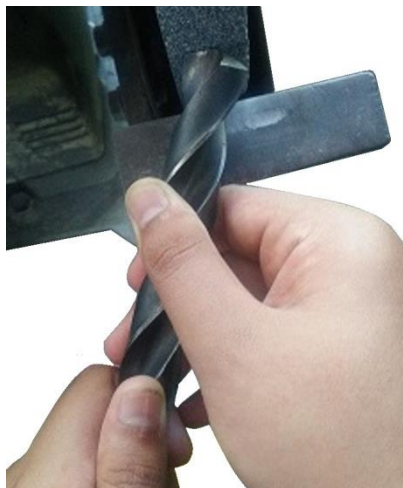
รูปที่ 5.31 แสดงลักษณะการลับมุมจิก 59 องศา ด้านที่ 1 (ที่มา : สุรัชย์ บุญโสภณ, 2559)
