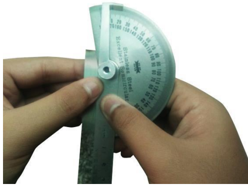
รูปที่ 4.78 แสดงการวัดตรวจสอบมุมเอียงคมตัดมีดกลึงปอกซ้าย (ที่มา : สุรัชย์ บุญโสภณ, 2559)
