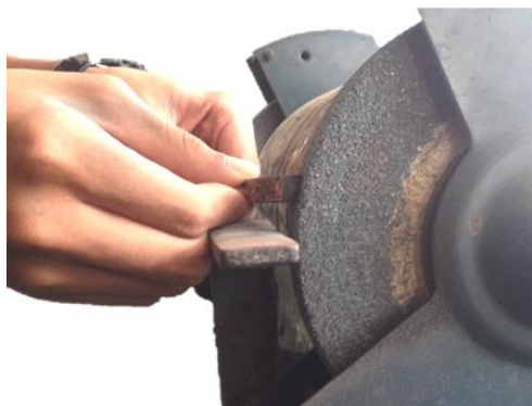
รูปที่ 4.54 แสดงการลับมุมหลบด้านข้าง (ที่มา : สุรัชย์ บุญโสภณ, 2559)
