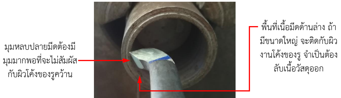
รูปที่ 4.147 แสดงลักษณะของมุมหลบปลายมีดกลึงคว้านรูใน (ที่มา : สรุชัย บุญโสภณ, 2559)
