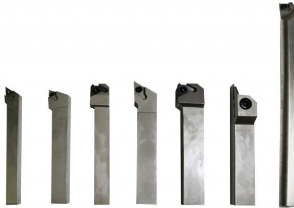
รูปที่ 4.33 แสดงลักษณะของด้ามจับเม็ดมีดแบบถอดเปลี่ยนได้ (ที่มา : http://www.pcamcnc.com , วันเข้าถึง 11 มิถุนายน 2559)
