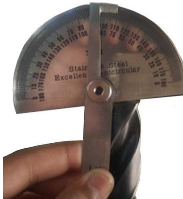
รูปที่ 5.33 แสดงลักษณะการวัดมุมหลบ 12 องศา ด้านที่ 1 (ที่มา : สุรัชชัย บุญโสภณ, 2559)
