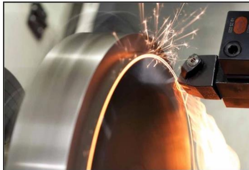
รูปที่ 1.18 แสดงเครื่องมือตัดแบบเม็ดมิดที่ใช้วัสดุ คิวบิกโบรอนไนไตรด์ (CBN) กลึงงานชุบแข็ง (ที่มา : https://toolingcafe.com/ , วันเข้าถึง 13 พฤษภาคม 2559)
