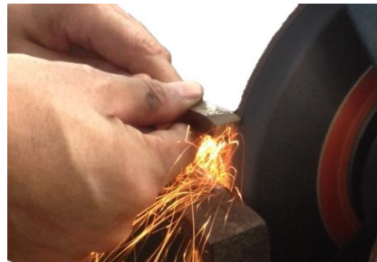
รูปที่ 4.89 แสดงการลับคมมีดปาดหน้าด้านที่ 3 (ที่มา : สุรัชย์ บุญโสภณ, 2559)
