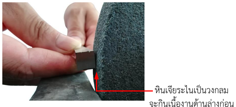
รูปที่ 4.103 แสดงการลับมุมหลบข้างซ้าย (ที่มา : สุรัชย์ บุญโสภณ, 2559)
