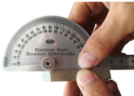
รูปที่ 4.141 แสดงการวัดตรวจสอบมุมคายหลังมีด (ที่มา : สุรัชย์ บุญโสภณ, 2559)
