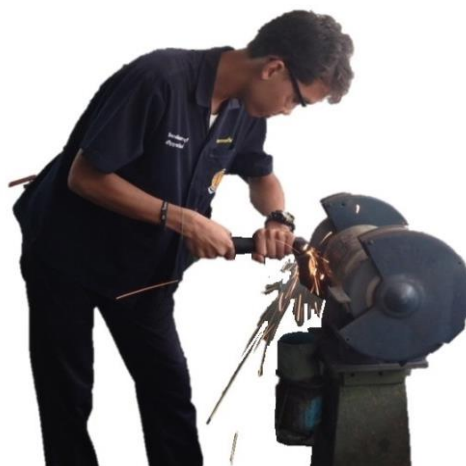
รูปที่ 3.14 แสดงลักษณะการจับด้ามล้อแต่งหน้าหินเจียรไนเพื่อแต่งหน้าล้อยินเจียรไน (ที่มา : สุรัชย์ บุญโสภณ, 2559)
