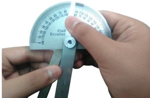
รูปที่ 4.84 แสดงการวัดตรวจสอบมุมรวมปลายมีด (ที่มา : สุรัชย์ บุญโสภณ, 2559)
