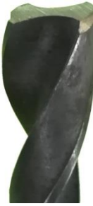
รูปที่ 5.29 แสดงลักษณะของปลายดอกสว่านที่ลับออกแล้ว (ที่มา : สุรัชย์ บุญโสภณ, 2559)
