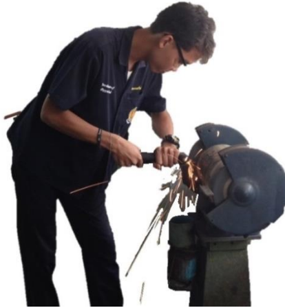
รูปที่ 5.26 แสดงลักษณะการแต่งหน้าล้อหินเจียรไน (ที่มา : สุรัชย์ บุญโสภณ, 2559)
