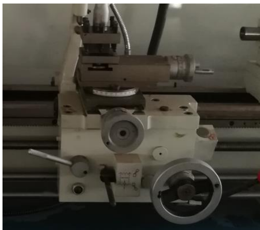
รูปที่ 4.10 แสดงลักษณะของชุดแท่นเลื่อนเครื่องกลึงยืนศูนย์ (ที่มา : สุรัชย์ บุญโสภณ, 2559)
