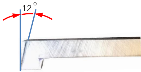
รูปที่ 4.154 แสดงลักษณะเส้นร่างบนมีดกลึงสำหรับลับมุมเอียงคมตัดด้านหน้า (ที่มา : สุรัชย์ บุญโสภณ, 2559)
