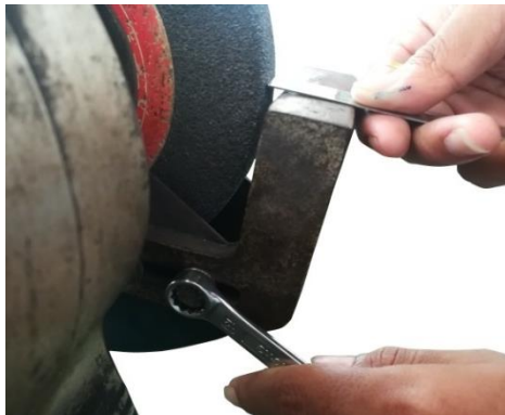
รูปที่ 5.27 แสดงการปรับระยะของแท่นรองรับชิ้นงานกับล้อหินเจียรไน (ที่มา : สุรัชย์ บุญโสภณ, 2559)
