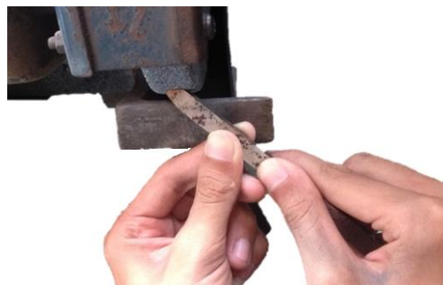
รูปที่ 4.60 แสดงการลับมุมรวมปลายมีด (ที่มา : สุรัชย์ บุญโสภณ, 2559)
