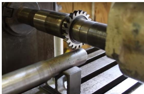
รูปที่ 2.28 แสดงลักษณะการกัดงานของมีดกัด
