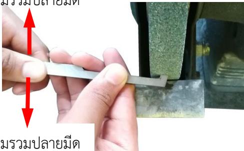
รูปที่ 4.165 แสดงแนวในการแก้ไขมุมรวมปลายมีดคลึงคว้านรูใน (ที่มา : สุรัชย์ บุญโสภณ, 2559)
