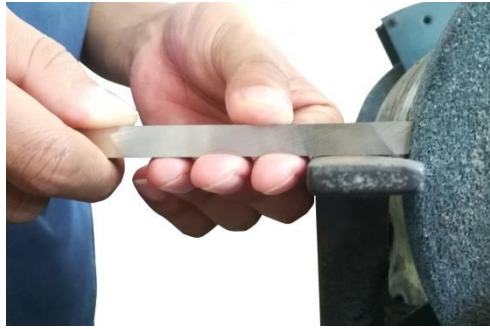
รูปที่ 4.96 แสดงการลับมุมหลบหน้ามีด (ที่มา : สุรัชชัย บุญโสภณ, 2559)
