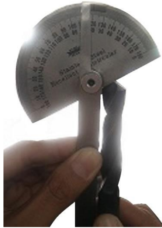
รูปที่ 5.34 แสดงลักษณะการวัดมุมจิก 59 องศา ด้านที่ 2 (ที่มา : สุรชัย บุญโสภณ, 2559)
