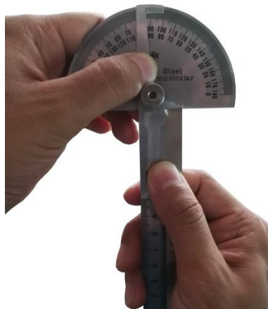
รูปที่ 4.97 แสดงการวัดตรวจสอบมุมฉากปลายมีด (ที่มา : สุรัชชัย บุญโสภณ, 2559)
