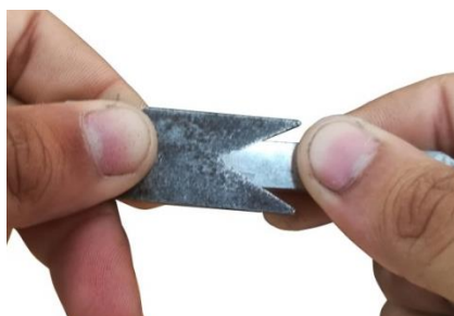
รูปที่ 4.133 แสดงการวัดตรวจสอบมุมรวมปลายมีด (ที่มา : สุรัชย์ บุญโสภณ, 2559)
