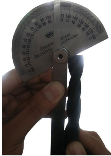
รูปที่ 5.32 แสดงลักษณะการวัดมุมจิก 59 องศา ด้านที่ 1 (ที่มา : สุรัชชัย บุญโสภณ, 2559)
