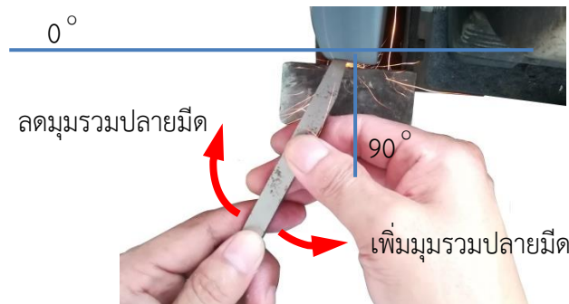
รูปที่ 4.86 แสดงแนวในการแก้ไขมุมรวมปลายมีด มีดกลึงปกซ้าย (ที่มา : สุรัชย์ บุญโสภณ, 2559)
