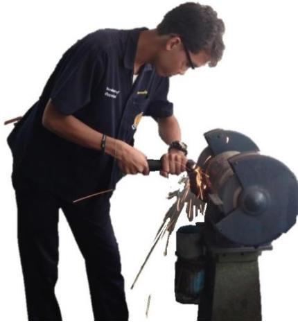
รูปที่ 4.51 แสดงลักษณะการแต่งหน้าล้อหินเจียระไน (ที่มา : สุรัชย์ บุญโสภณ, 2559)
