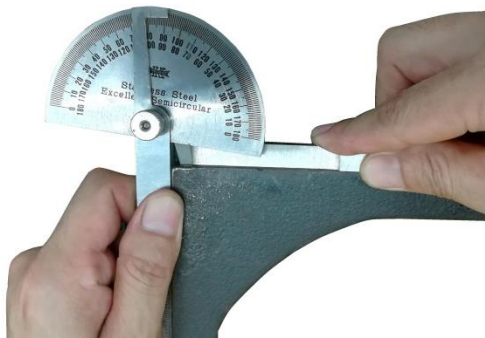
รูปที่ 4.168 แสดงการวัดตรวจสอบมุมคายหลังมีด (ที่มา : สุรัชชัย บุญโสภณ, 2559)
