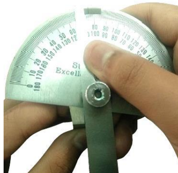
รูปที่ 4.90 แสดงการวัดตรวจสอบมุมคายข้าง (ที่มา : สุรัชย์ บุญโสภณ, 2559)
