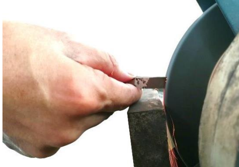
รูปที่ 4.83 แสดงการลับมุมหลบหน้ามีด (ที่มา : สุรัชย์ บุญโสภณ, 2559)
