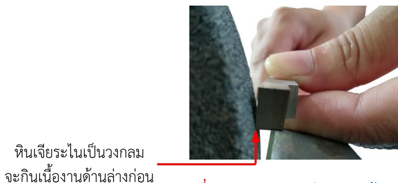
รูปที่ 4.110 แสดงการลับมุมหลบข้างขวา (ที่มา : สุรัชย์ บุญโสภณ, 2559)
