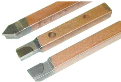
รูปที่ 4.31 แสดงลักษณะของเม็ดมีดกลึงคาร์ไบด์ที่เชื่อมติดกับด้ามแล้ว (ที่มา : https://machinemechanics.wordpress.com , วันเข้าถึง 10 พฤษภาคม 2559)
