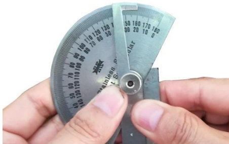
รูปที่ 4.127 แสดงการวัดตรวจสอบมุมเอียงด้านแรก 30 องศา (ที่มา : สุรัชย์ บุญโสภณ, 2559)
