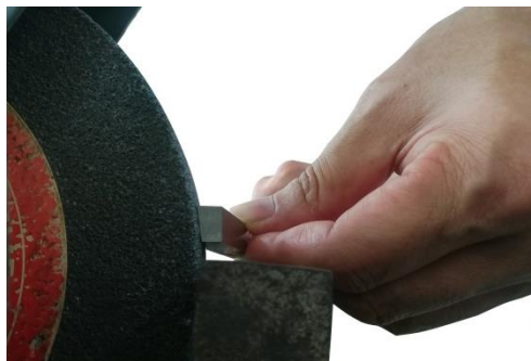
รูปที่ 4.77 แสดงการลับมุมหลบด้านข้างมีดกลึงปอกซ้าย (ที่มา : สุรัชย์ บุญโสภณ, 2559)
