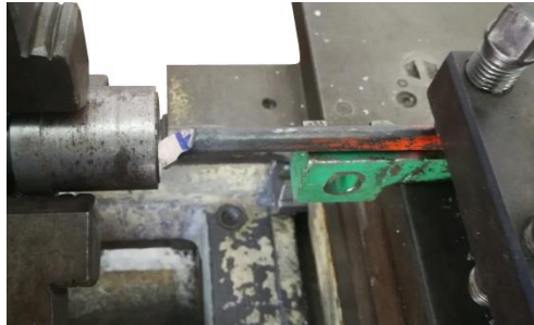
รูปที่ 4.142 แสดงลักษณะการกลึงคว้านรูใน (ที่มา : สุรัชย์ บุญโสภณ, 2559)
