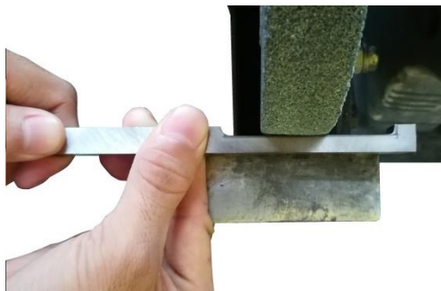
รูปที่ 4.152 แสดงการลับร่องมีดกลิ้งที่เป็นร่องแล้ว (ที่มา : สุรชัย บุญโสภณ, 2559)
