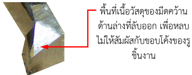
รูปที่ 4.148 แสดงลักษณะของมีดที่ลับเพื่อลดพื้นที่ด้านล่างของมีดคว้านรูใน (ที่มา : สรุชัย บุญโสภณ, 2559)
