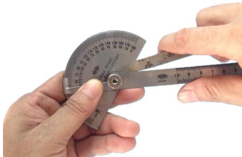
รูปที่ 4.62 แสดงการวัดตรวจสอบมุมรวมปลายมีด (ที่มา : สุรัชย์ บุญโสภณ, 2559)
