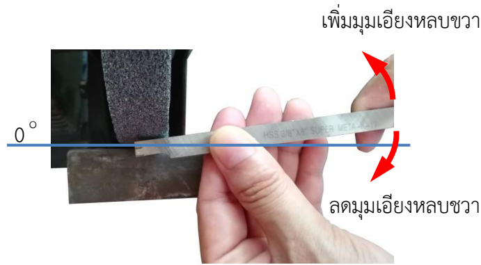
รูปที่ 4.115 แสดงแนวในการแก้ไขมุมเอียงหลบขวา (ที่มา : สุรัชชัย บุญโสภณ, 2559)
