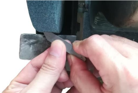
รูปที่ 4.131 แสดงการลับมุมเอียงด้านที่ 2 ให้เกิดมุมรวมปลายมีด 60 องศา (ที่มา : สุรัชย์ บุญโสภณ, 2559)
