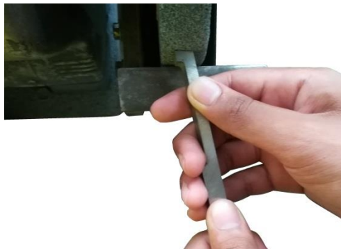
รูปที่ 4.155 แสดงลักษณะการลับมุมเอียงคมตัดด้านหน้า (ที่มา : สุรัชย์ บุญโสภณ, 2559)
