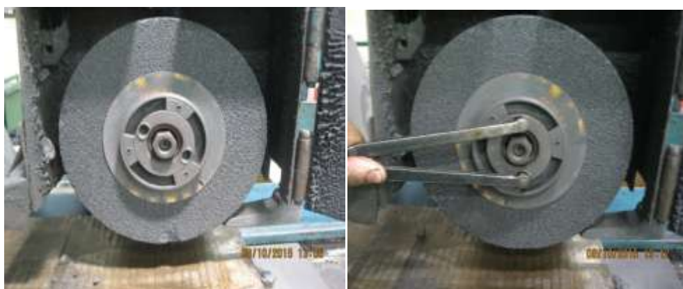
รูปที่ 4.19 ลักษณะการติดตั้ง รูปที่ 4.20 การใช้ประแจถอดและประกอบ (ที่มา : มนัส นิระโส, 2559)
