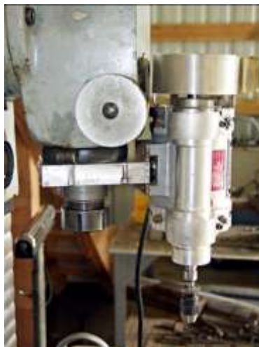
รูปที่ 2.14 อุปกรณ์ที่ใช้เพื่อให้เครื่องกัดนอนสามารถกัดตั้งได้
