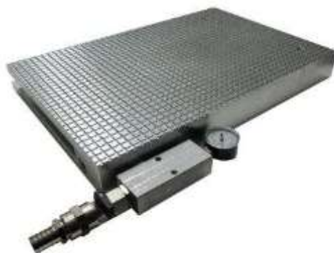
รูปที่ 4.10 แท่นจับยึดชิ้นงานโดยใช้ระบบจับยึดแบบสุญญากาศ
