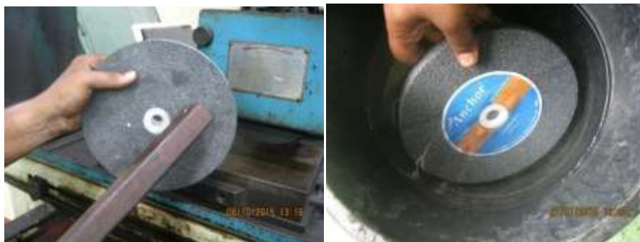
รูปที่ 4.17 การตรวจสอบโดยใช้ไม้เคาะ รูปที่ 4.18 หินเจียรไนชุบน้ำเพื่อรักษาความชื้น (ที่มา : มนัส นิระโส, 2559)
