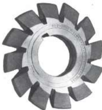
รูปที่ 2.37 Cutter สำหรับกัดเฟือง (ที่มา : https://en.wikisource.org )
