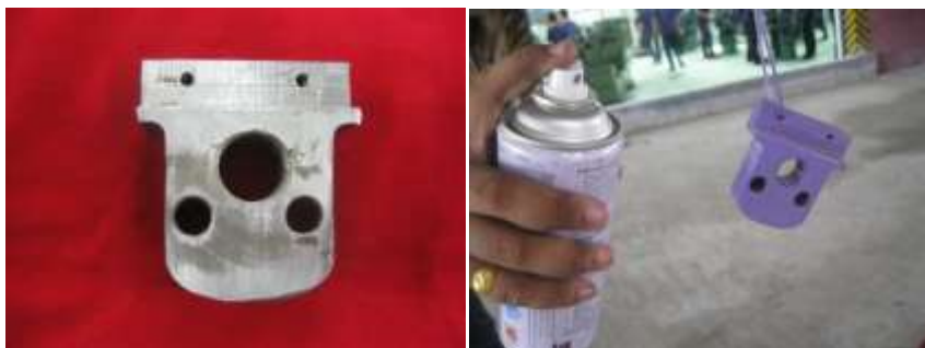
ชิ้นงานที่ 11 ปากจับปากกานำเลื่อน ชิ้นงานที่ 11 พ่นสีปากจับปากกานำเลื่อน (ที่มา: มนัส นิระโส,2559) (ที่มา: มนัส นิระโส,2559)
