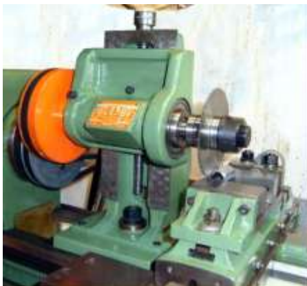
รูปที่ 2.16 อุปกรณ์พิเศษเพื่อใช้สำหรับกัดเฟืองสะพานเครื่องกัดนอน (ที่มา : http://www.lathes.co.uk )
