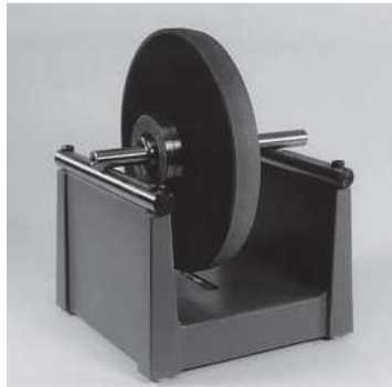
รูปที่ 4.12 การติดตั้งล้อหินบนชุดตั้งความสมดุลบนล้อหิน (ที่มา : http://www.neotools1.com )
