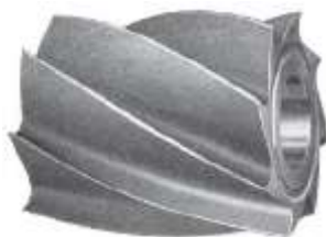
รูปที่ 2.19 ดอกกัดสำหรับงานกัดผิวราบ (ที่มา : https://en.wikisource.org )
