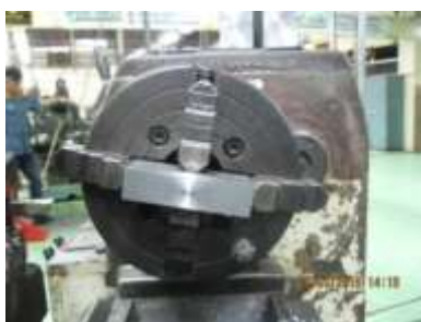
รูปที่ 1.7 ลักษณะการจับยึดชิ้นงานด้วยฟันอิสระ ที่มา : มนัส นิระโส, 2559
