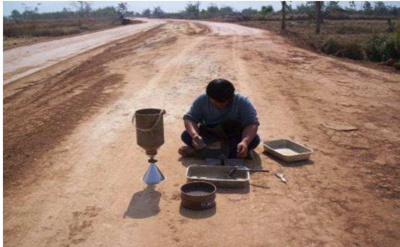
รูปที่ 4.15 แสดงการทดสอบความหนาแน่นเมื่อบดอัดแล้ว
