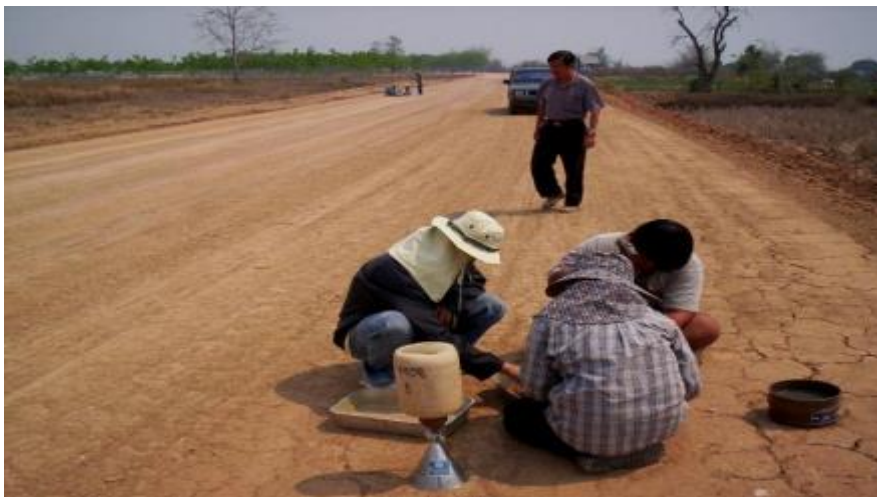
รูปที่ 4.20 แสดงการทดสอบความหนาแน่นเมื่อบดอัดแล้ว
