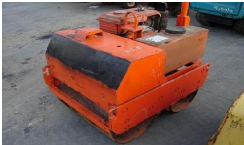
รูปที่ 4.38 แสดงเครื่องบดอัดถนนแบบเดินตาม
