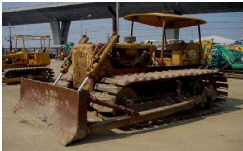
รูปที่ 4.43 แสดงรถดันดิน ล้อตีนตะขาบ
