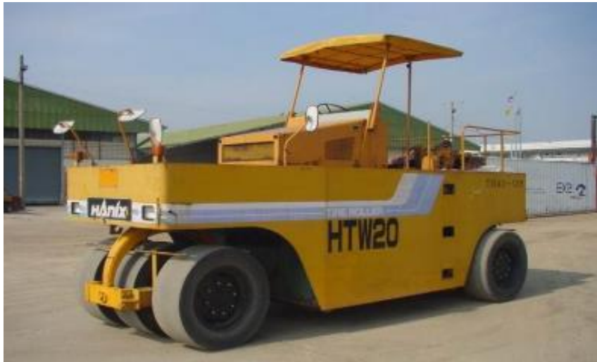
รูปที่ 4.35 แสดงรถบดล้อยาง
