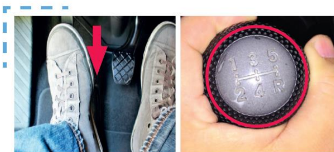
รูปที่ 6.2 แสดงเหยียบแป้นคลัตช์จนสุด เลื่อนคันเข้าเกียร์ 1
