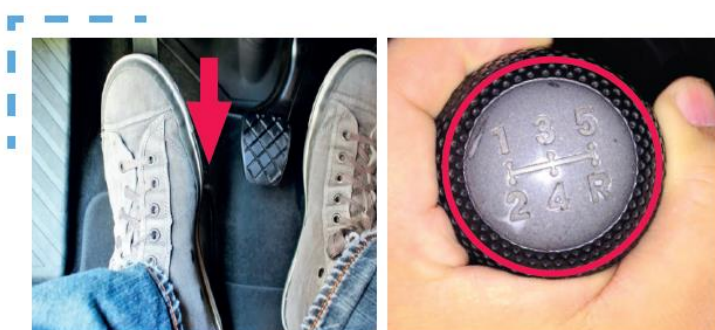
รูปที่ 7.7 แสดงเหยียบแป้นคลัตช์จนสุด เลื่อนคันเข้าเกียร์ไป 1
