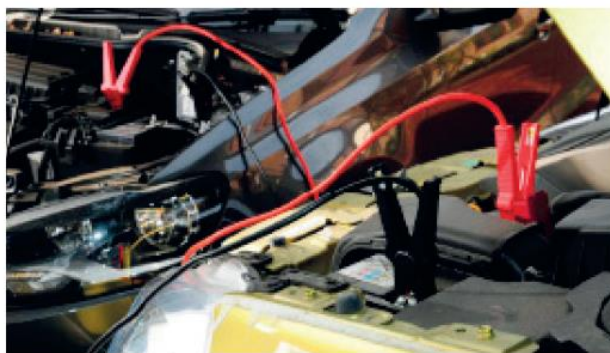
รูปที่ 10.3 แสดงการต่อพ่วงแบตเตอรี่รถยนต์
