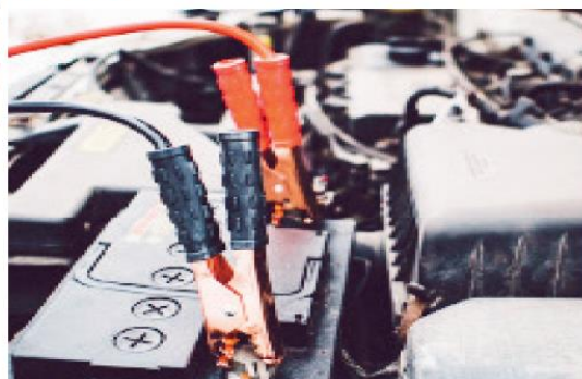
รูปที่ 10.2 แสดงการต่อขั้วแบตเตอรี่จากรถพ่วง
