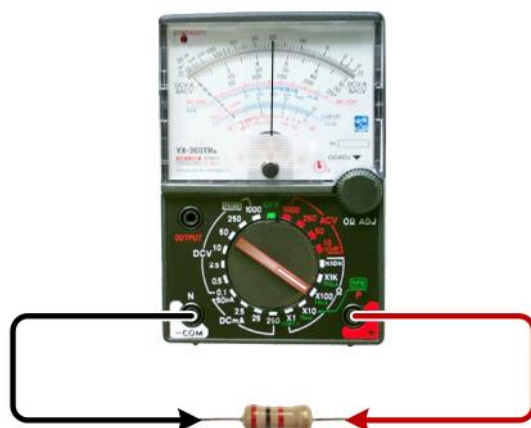
รูปที่ 2.7 การวัดความต้านทานด้วยโอห์มมิเตอร์
