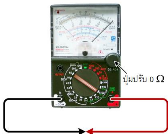
รูปที่ 2.6 การปรับแต่งโอห์มมิเตอร์ให้ชี้ที่ 0 \Omega พอดี
