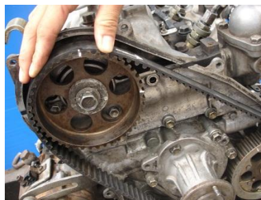
รูปที่ 2.7 แสดงรูปนำสายพานมาคล้องกับเฟืองเพลาลูกเบี้ยว
