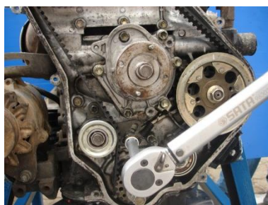
รูปที่ 2.10 แสดงรูปใช้ประแจกระบอก หมุนเพลาข้อเหวี่ยง ไป 2 รอบ
