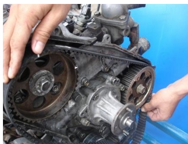
รูปที่ 2.8 แสดงรูปจัดเครื่องหมายของเฟืองไทม์มิ่งปั๊มให้ตรงกับตัวเรือนปั๊มน้ำมันเครื่อง
