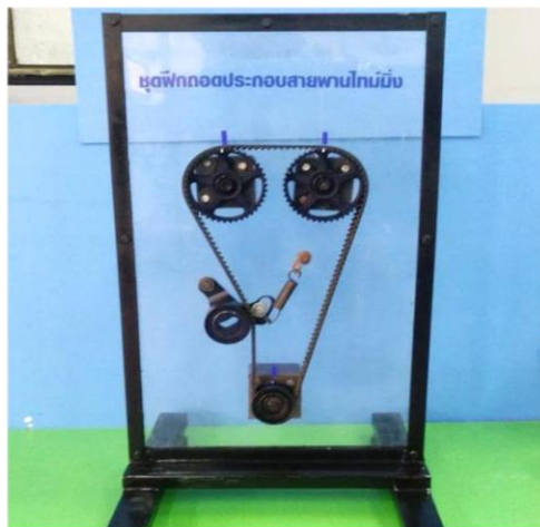
รูปที่ 4.1 แสดงรูปชุดฝึกปฏิบัติการถอด-ประกอบสายพานไทมิ่ง เครื่องยนต์ดีเซล
