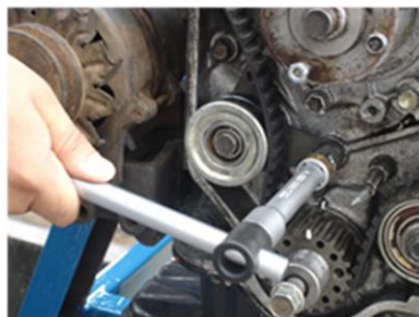
รูปที่ 2.5 แสดงรูปใช้ประแจกระบอก คลายแป้นเกลียวยึดลูกกลิ้งกดสายพาน
