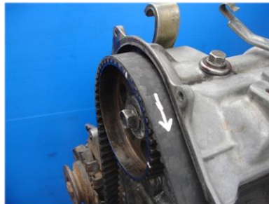
รูปที่ 2.4 แสดงรูปทำเครื่องหมายที่สายพาน
