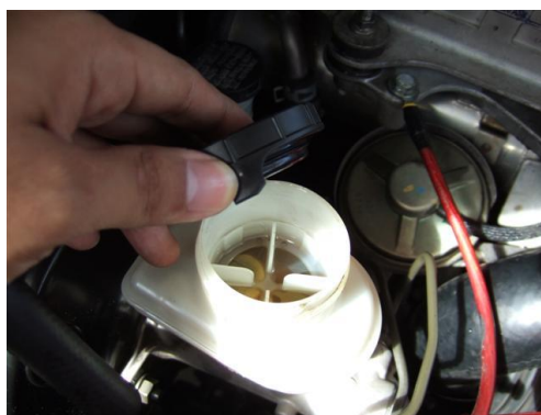
รูปที่ 2.5 การเติมน้ำมันเบรกและน้ำมันคลัตช์
